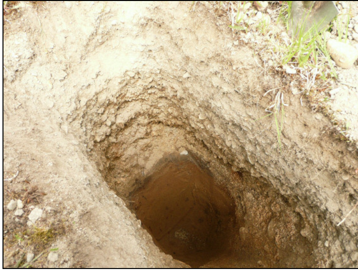
Koekuoppa 11 – täytemaata ja alla puhdas hiekkamaa.
