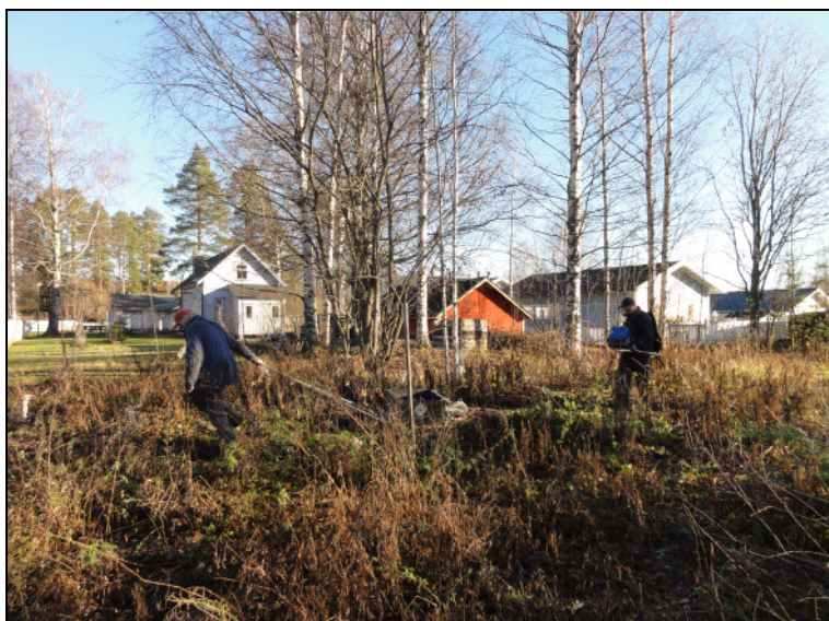
Maatutkausta 200 mHz antennilla. ja alla 400 mHz antennilla.
