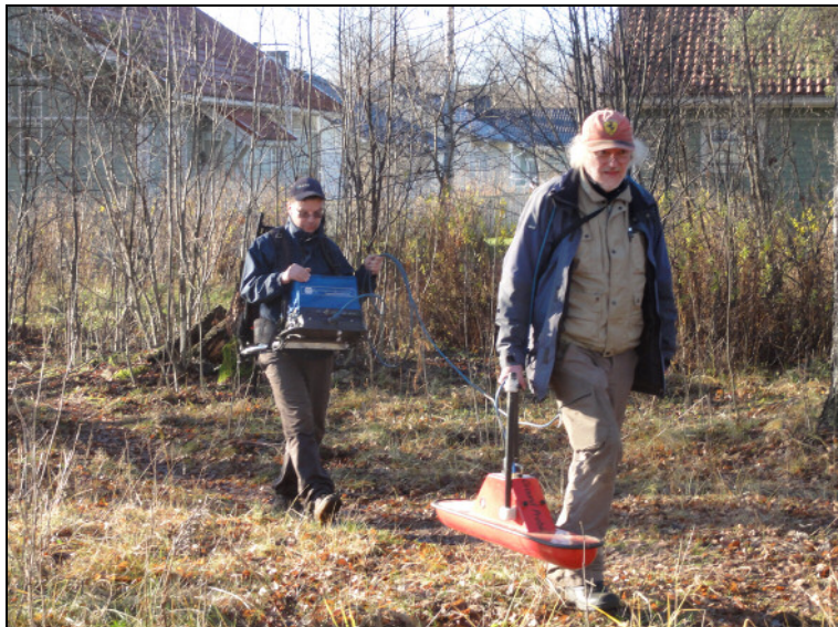
Maatutkausta 200 mHz antennilla. ja alla 400 mHz antennilla.
